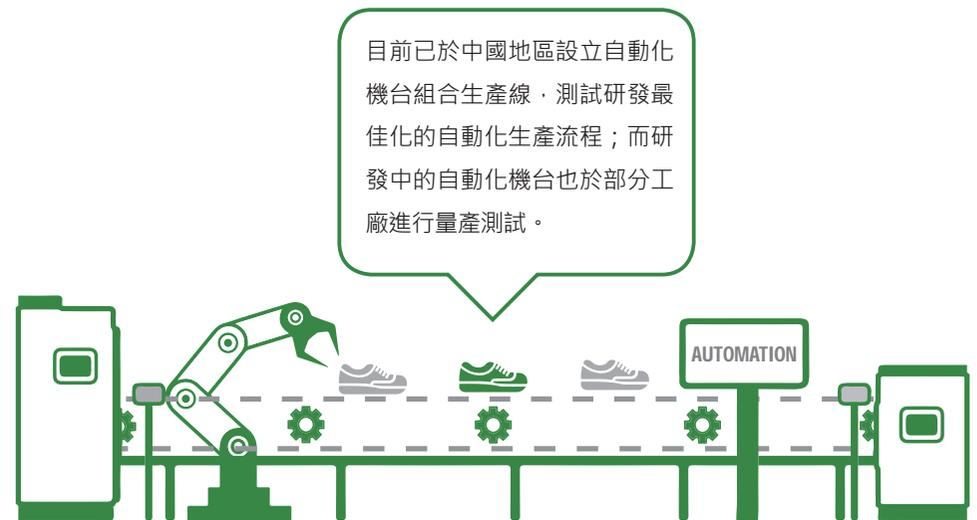
另外，我們透過引進或開發新機台，導入新的製造技術，以讓客戶在銷售上佔有優勢進行行銷。譬如在冰刀鞋鞋殼部分，導入特殊立體旋轉軸心之針車機台，使其在車縫時，可依物件角度不同360°旋轉，順利完成一體式3D射出鞋殼之設計外觀。在頭盔部分，開發水性發泡粉及吸塑流程，取代傳統二次冷熱定型做法，達到精簡流程並改善成品不良率。
